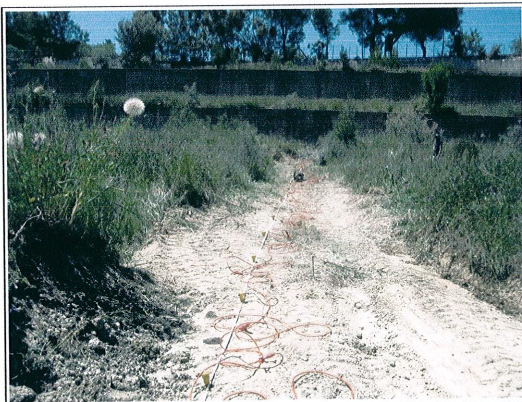
**Foto n.4 – Stesa sismica SS2 -**
