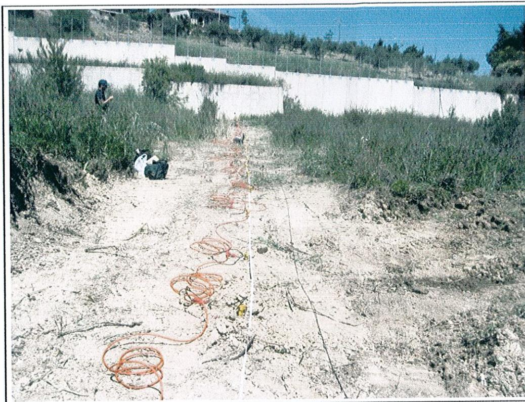
**Foto n.3 – Stesa sismica SS1 -**
